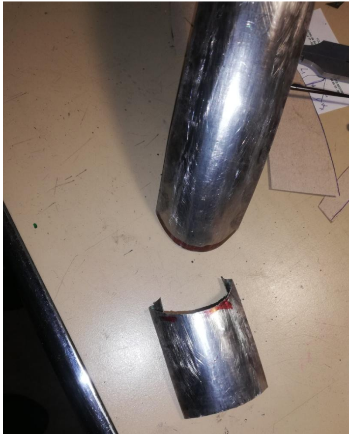
Mise à longueur par la coupe des extrémités, façon garde-boue arrière.
