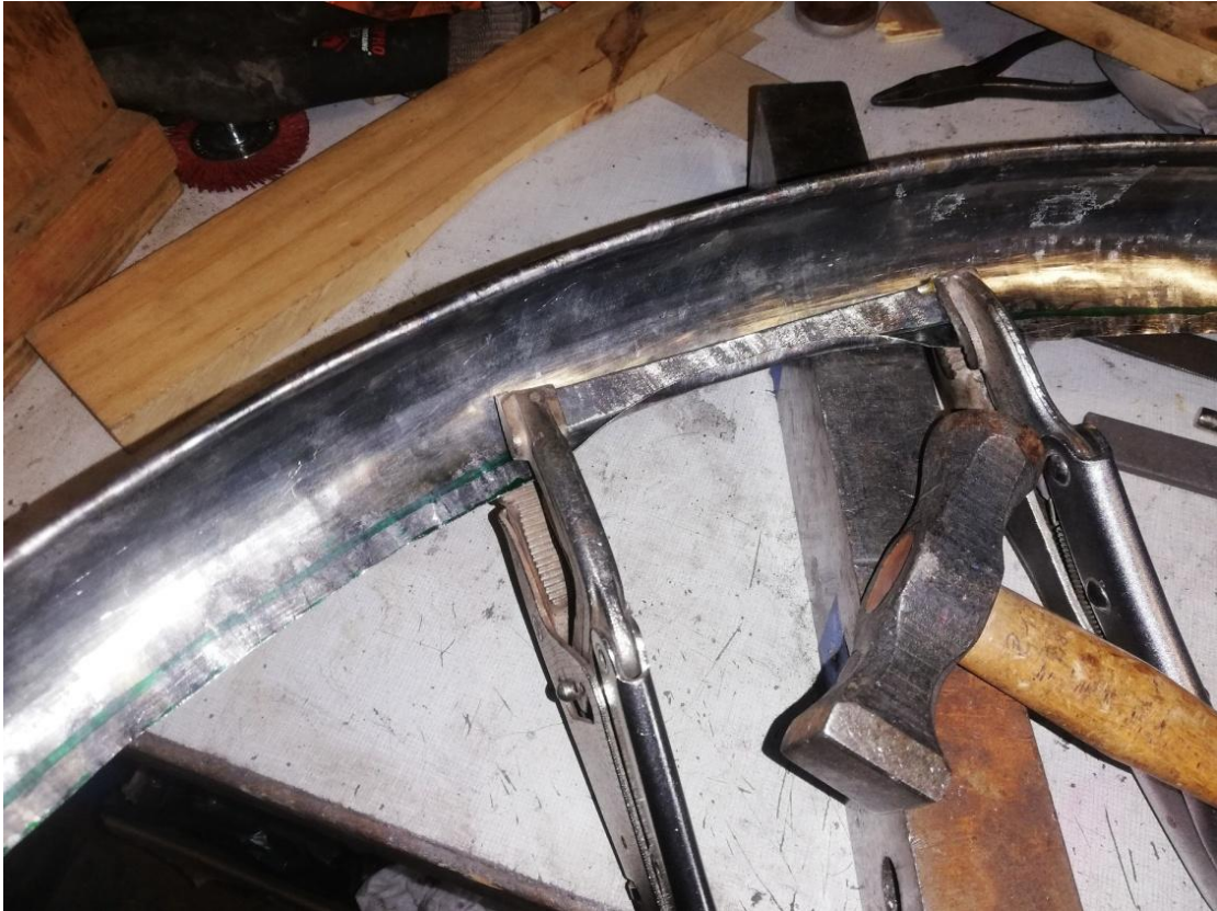
Mise à longueur par la coupe des extrémités, façon garde-boue arrière.
